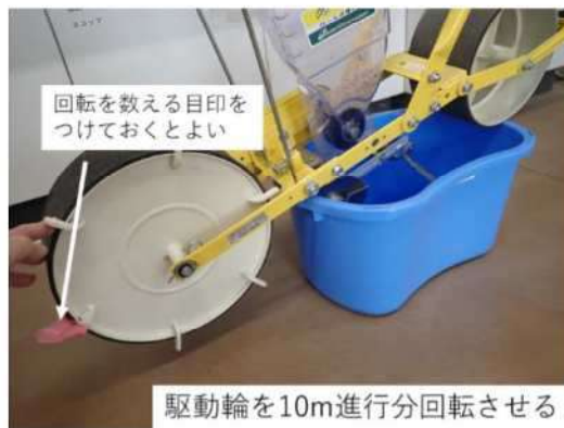
図 6-2 播種量の計測方法
