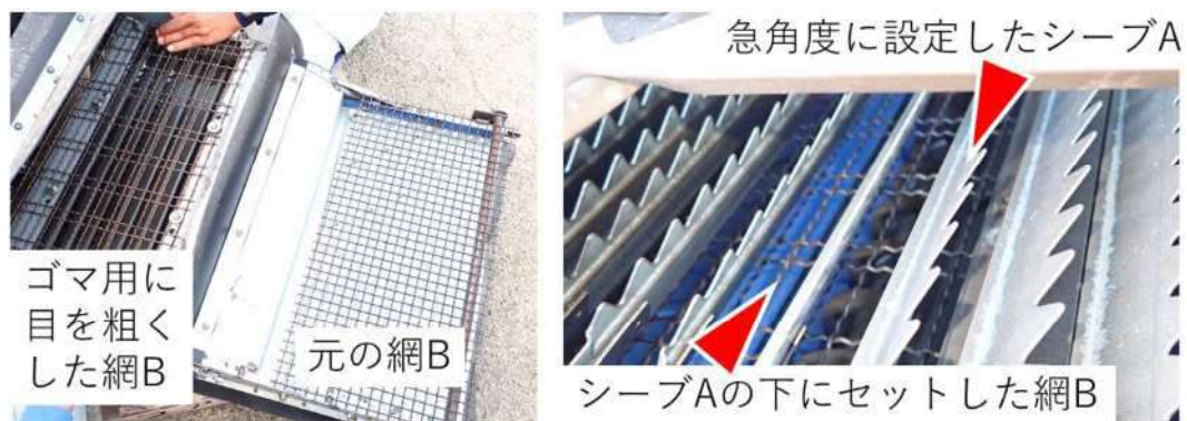
図 9-4 白脱型コンバインの網目とシープの変更
